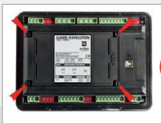
PRESS THE FINS TO OPEN THE LID
