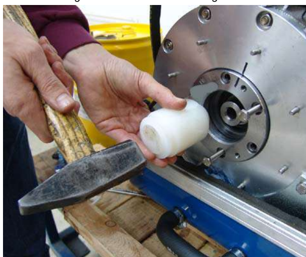
Fig. 7.10.1.3-4: 'Attach bearing case
