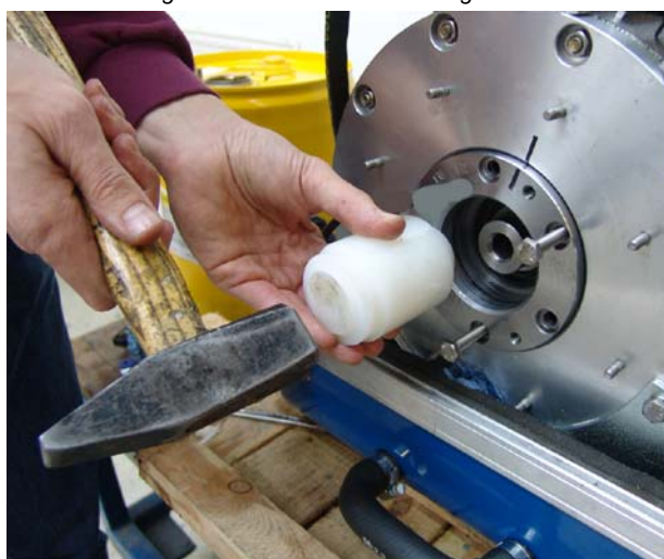
Fig. 7.10.1.3-4: 'Attach bearing case
