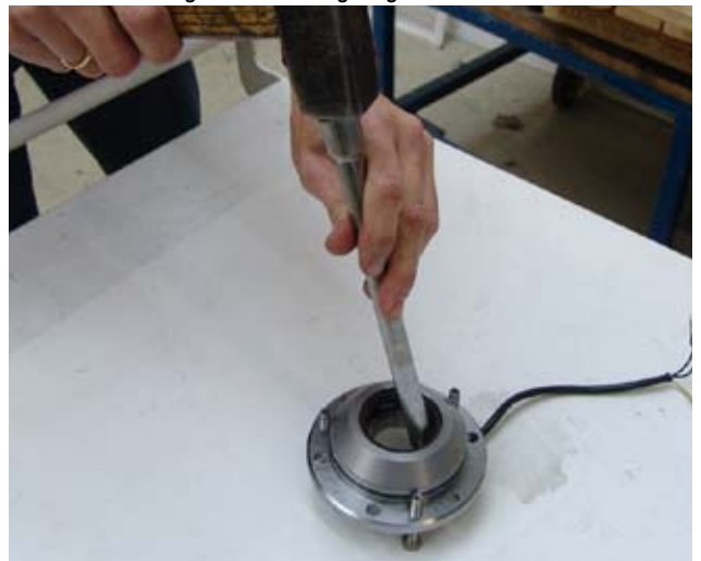
Fig. 7.19.2-8: Kugellager austreiben
