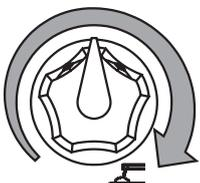
Den Schalter Schweißstromregler (T) entsprechend dem gewählten Schweißstrom einstellen, um die notwendige Amperezahl zu erhalten. Dabei ist der Elektrodentyp und der Durchmesser zu berücksichtigen.
