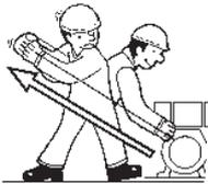
Positionner de façon appropriée pour démarrer, puis tirer avec décision la corde de démarrage
