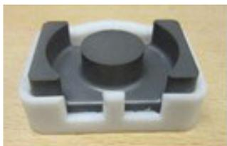
Prima di rimontare la ferrite, è necessario inserirla nella protezione in PTFE.
