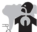
I fumi, gas e polveri emesse dalla saldatura sono pericolosi per la salute. È necessario prevedere una ventilazione sufficiente: potrebbe rendersi necessario un apporto d'aria. Una maschera ad aria fresca potrebbe essere una soluzione in caso di aerazione insufficiente.
