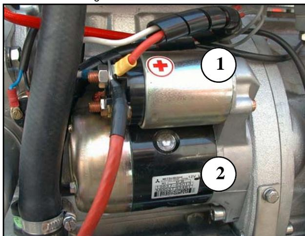
Fig. 5.11.2-4: Connection starterbattery 12V - schema
